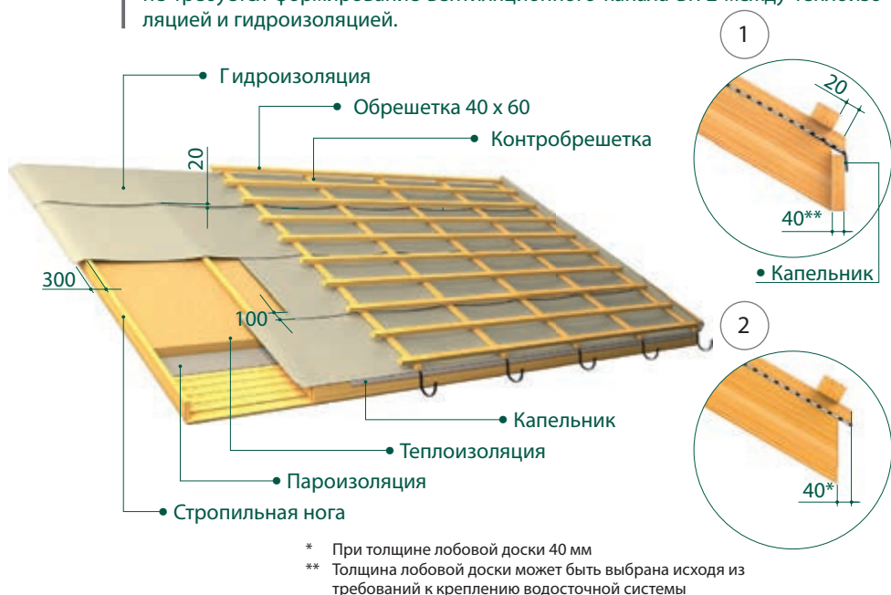
РИС. 3. Подготовка стропильной конструкции
