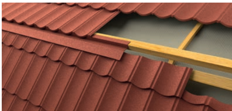
Рис. 34 Монтаж черепицы на внешнем переломе ската
