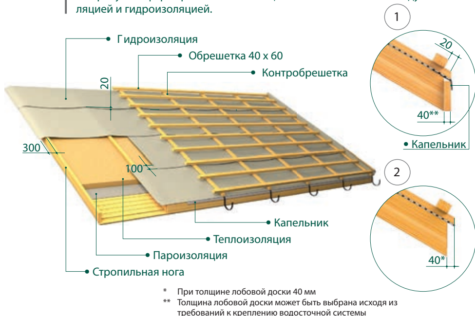
РИС. 3. Подготовка стропильной конструкции
