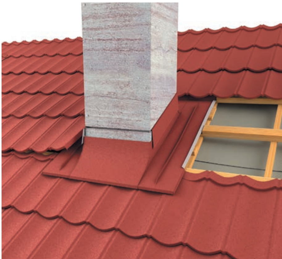
РИС. 32. 1 Примыкание к дымоходу с помощью оклада
