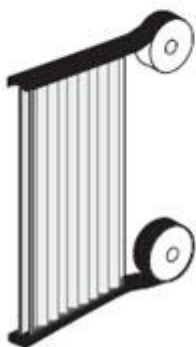
Рисунок 17б. Заклеивание открытых концов панели
