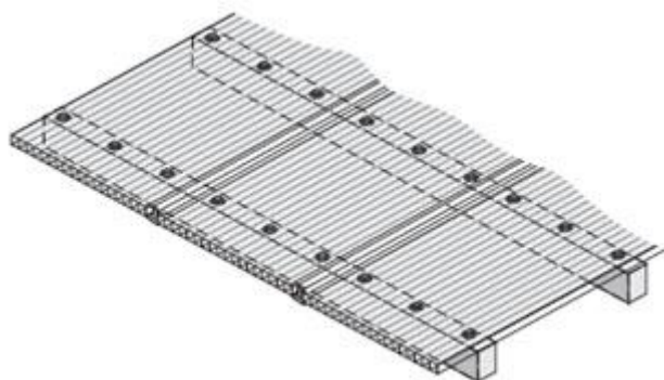
Рисунок 5. Обшивка плоской кровли
