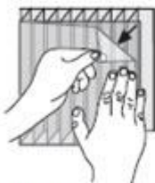
Рисунок 17б. Заклеивание открытых концов панели
