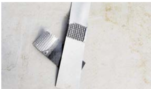
Рис. 5.2.10 Вырезание тестовой полоски из сварного шва
