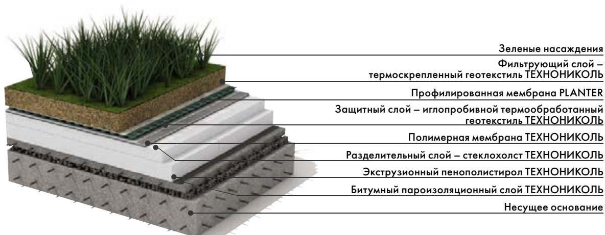
Рис. 2.4.6 Система полимерной «зеленой» кровли
