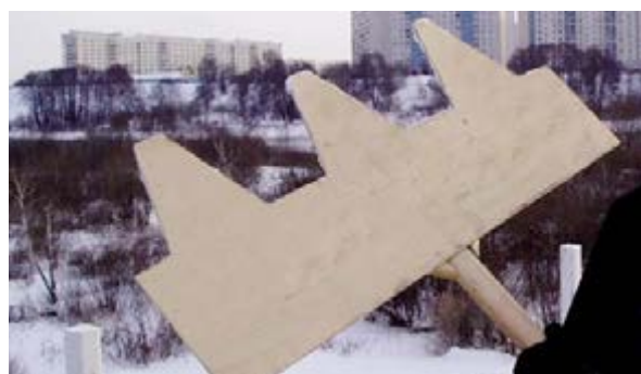
Рис. 3.1.2 Удаления снега и воды из гофр профилированного листа специальной лопатой
