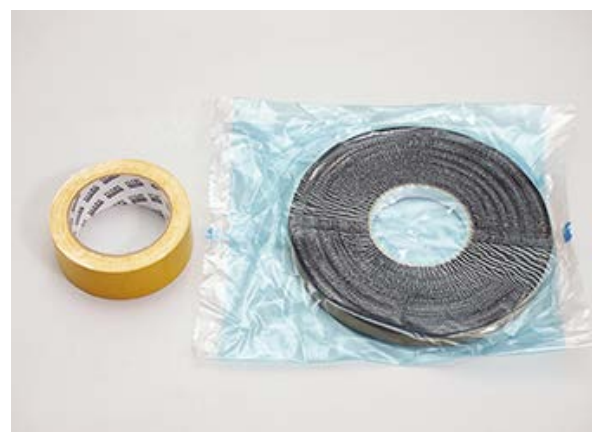
Рис. 4.4.6 Двусторонний скотч и бутил-каучуковая лента для проклейки швов пароизоляции
