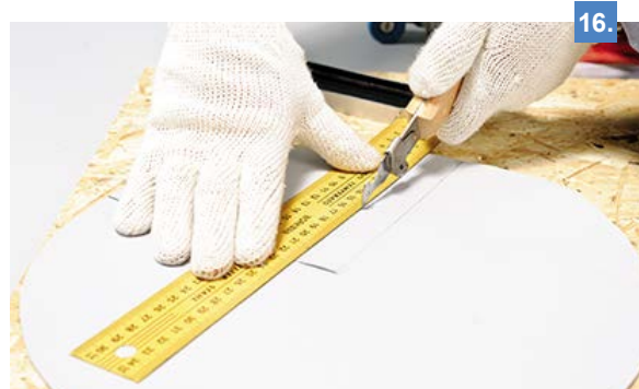
16. Отступив на 20 мм от линии сгиба сделайте разрез кровельным ножом
