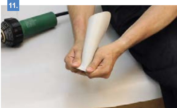
11. Прогретый угол растягивается до получения детали, как показано на рисунке. При необходимости операции 10-11 повторяются.
