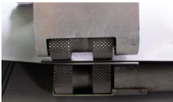
Рис. 5.2.11 Приводные ролики аппарата Twinny T
