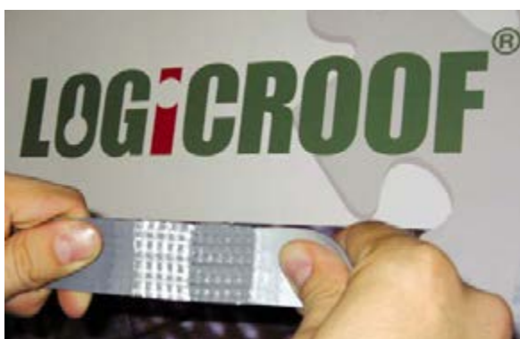
Рис. 5.2.3 Когезионный разрыв сварного шва неармированной и армированной мембраны
