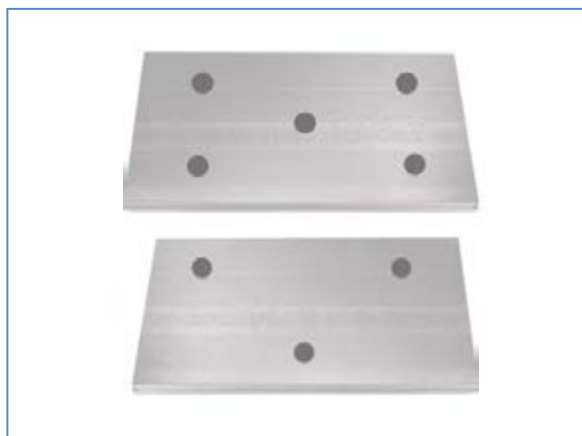
Рис. 2.6.3 Нанесения клея ТехноНИКОЛЬ на плиты ТЕХНОНИКОЛЬ
