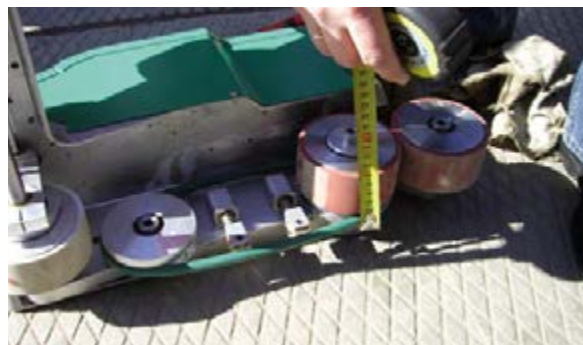
Рис. 3.5.5 Ширина рабочей поверхности Leister Varimat, равная 60 мм
