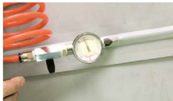
Рис. 5.2.13 Проверка герметичности с использованием сквозного канала
