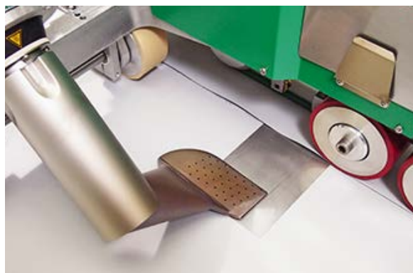
Рис. 5.2.6 Сварка с использованием металлической пластинки
